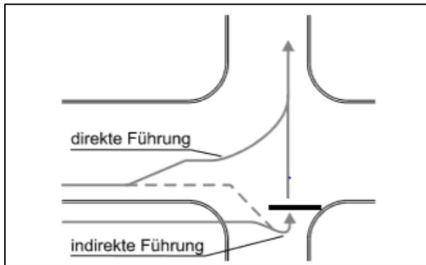
Abbildung 40: Linksabbiege-Führungsmöglichkeiten für Radfahrer. Quelle: (FGSV, 2010).
