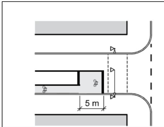
überfahren und damit gesichert sowohl rechts als auch links abbiegen. Außerdem ergeben sich Zeitvorteile für die Radfahrer und eine verbesserte Aufenthaltsqualität, da sie nicht zwischen den Fahrzeugen warten müssen. Diese Führungsform eignet sich gut für untergeordnete Knotenpunktarme, an denen es keine Fahrstreifenaufweitungen für Abbieger gibt.
