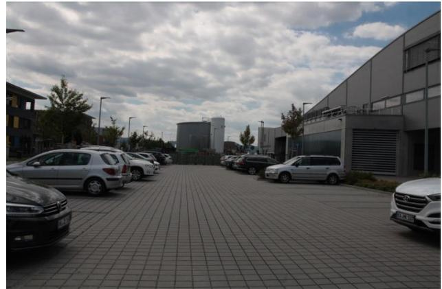
Abbildung 62 - Flächenbefestigung mit offenen, wasserdurchlässigen Fugen (Bild: faktorgruen).
