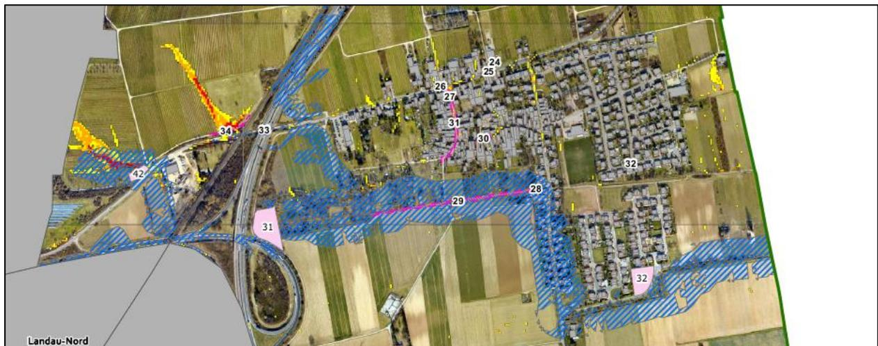
Abbildung 38: Ausschnitt aus der Detailkarte mit dem Maßnahmenkonzept in Dammheim (Anlage 8.1) mit Darstellung der Entstehungs- und Wirkungsbereiche bei Starkregen
