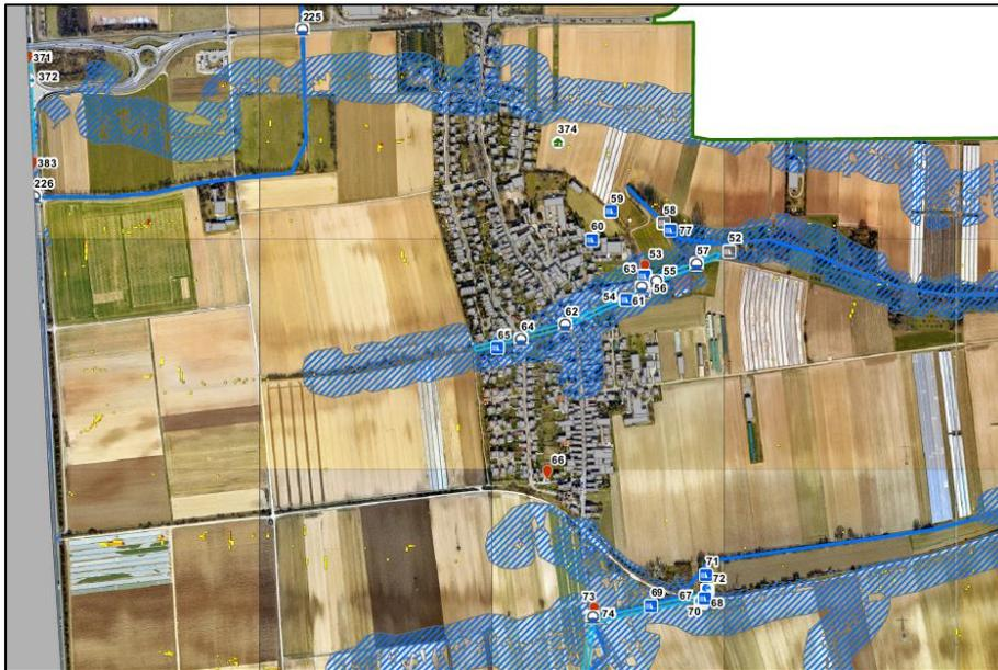
Abbildung 21: Ausschnitt aus der Detailkarte mit den Erkenntnissen aus der öffentlichen Ortsbegehung in Mörlheim (Anlage 4.1) mit Darstellung der Fließwege, Entstehungs- und Wirkungsbereiche bei Starkregen
