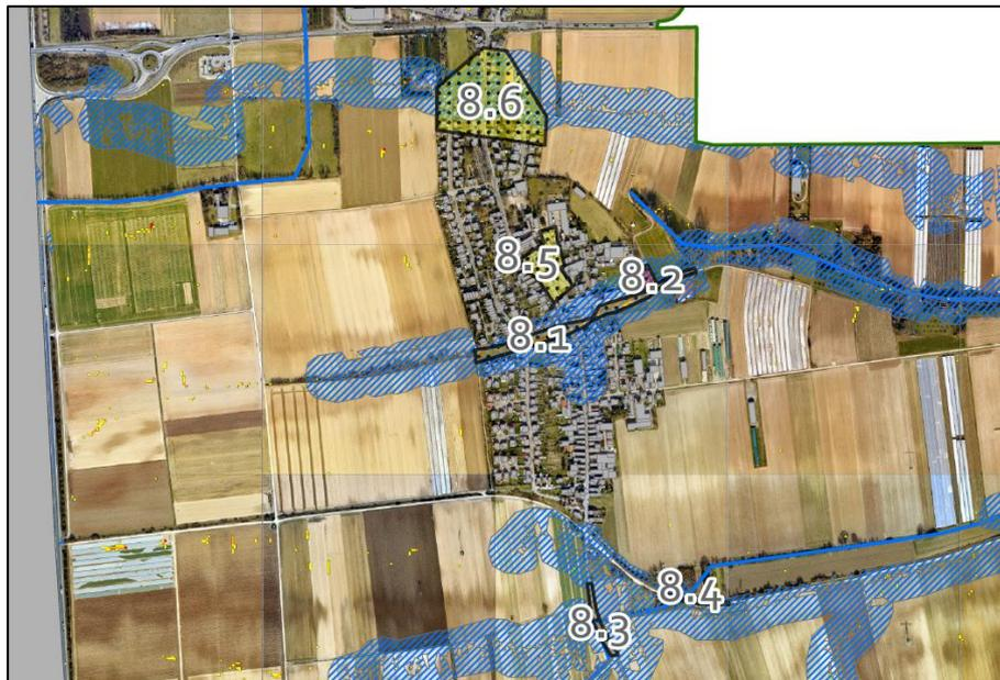
Abbildung 46: Ausschnitt aus der Detailkarte mit den Defizitbereichen in Mörlheim (Anlage 7.1) mit Darstellung der Entstehungs- und Wirkungsbereiche bei Starkregen
