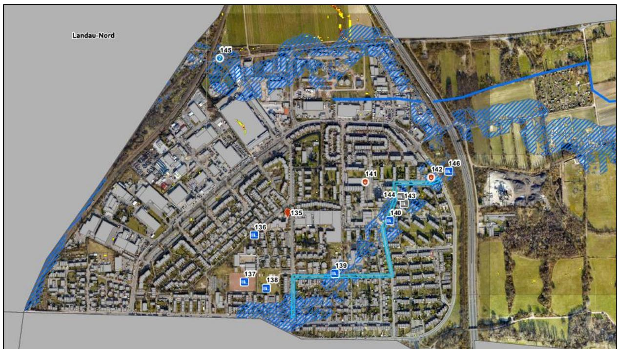
Abbildung 20: Ausschnitt aus der Detailkarte mit den Erkenntnissen aus der öffentlichen Ortsbegehung in Landau-Horst (Anlage 4.1) mit Darstellung der Fließwege, Entstehungs- und Wirkungsbereiche bei Starkregen
