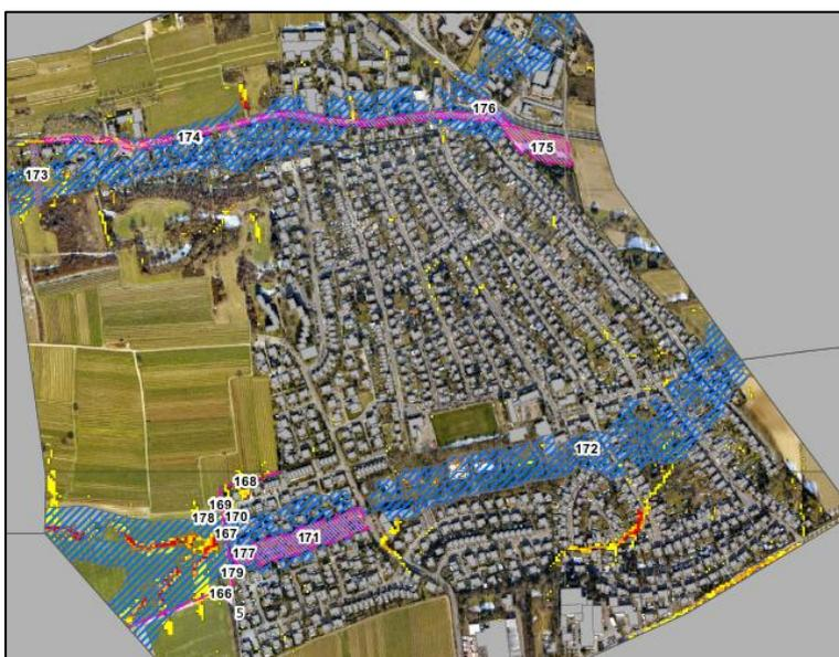
Abbildung 52: Ausschnitt aus der Detailkarte mit dem Maßnahmenkonzept in Landau-Südwest (Anlage 8.1) mit Darstellung der Entstehungs- und Wirkungsbereiche bei Starkregen
