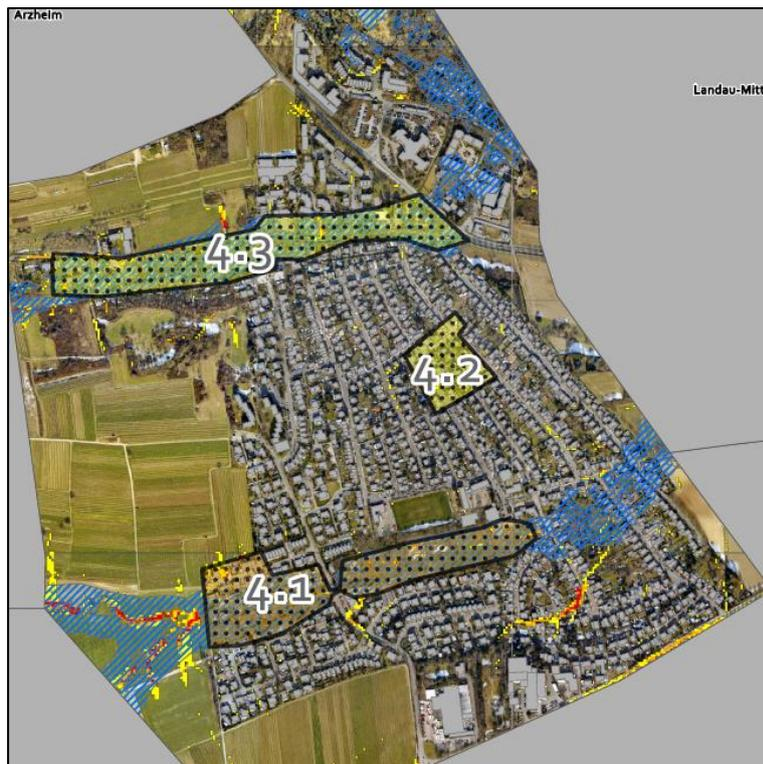
Abbildung 43: Ausschnitt aus der Detailkarte mit den Defizitbereichen in Landau-Südwest (Anlage 7.1) mit Darstellung der Entstehungs- und Wirkungsbereiche bei Starkregen
