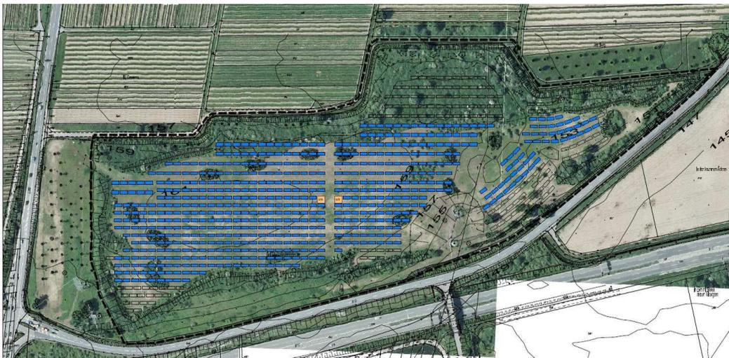
**Abb. 4:** Geplante Aufstellung der Solar-Modultische (blau) im Plangebiet (schwarze Strichelung). Ausschnitt aus einem Plan von L.A.U.B. (2011).
