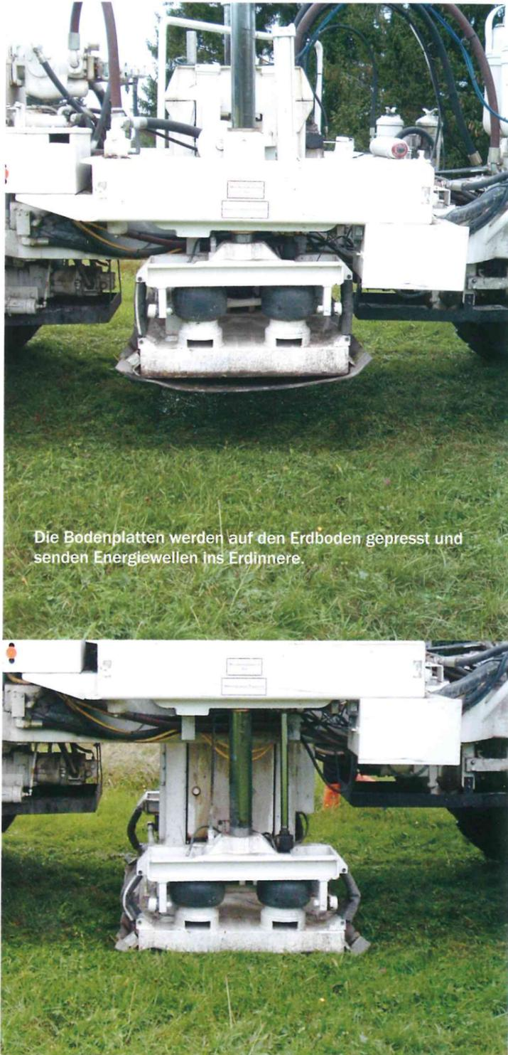
Die Bodenplatten werden auf den Erdboden gepresst und senden Energiewellen ins Erdinnere.
