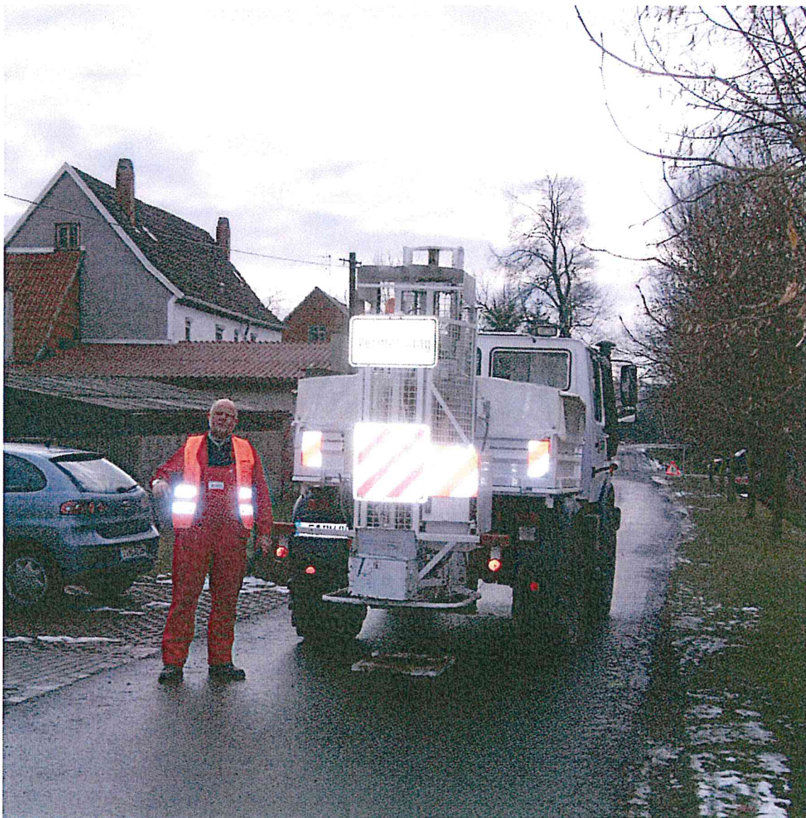
Abb. 4: Ein Fallgewicht an einem Unimog montiert.
