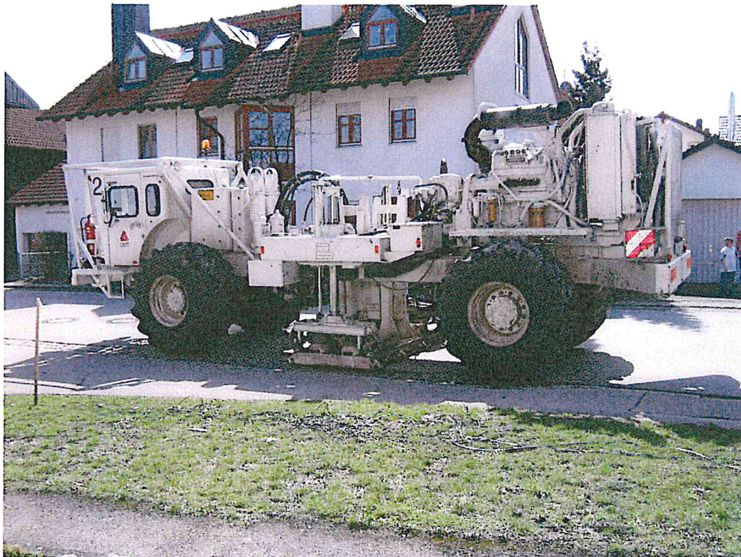
Abb. 3: Vibratorfahrzeug. Die eingesetzten Vibratorfahrzeuge können ein anderes Modell als das hier abgebildete sein.
